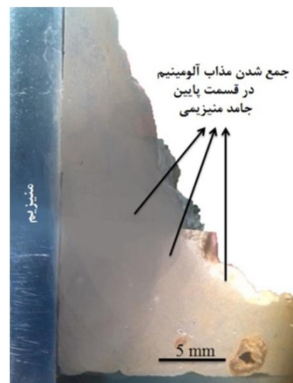
شکل 7 نمونه‌ی بدون پیش گرم، جمع شدن آلومینیم در قسمت پایین جامد
